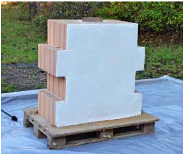
» Trial wall (brick with clay plaster) for demonstration purposes » Versuchswand (Ziegel mit Lehmputz) zur Demonstration
