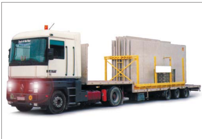
Bild 18: Tiefbettsattel mit beladener Transportbox
