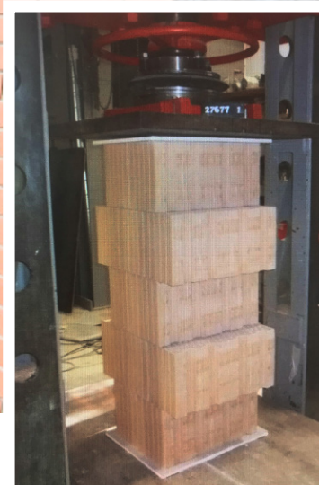
Ziegel werden mit dem patentierten System ohne Mörtel zusammengehalten
